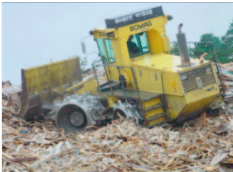
Her ser man kompaktoren i full gang med å komprimere trevirke fra gjenbruksstasjonen.
