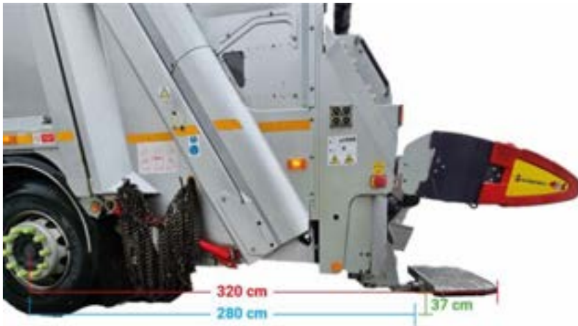
Figur 4.4. Målsatt bilde av overhenget på renovasjonskjøretøy.
