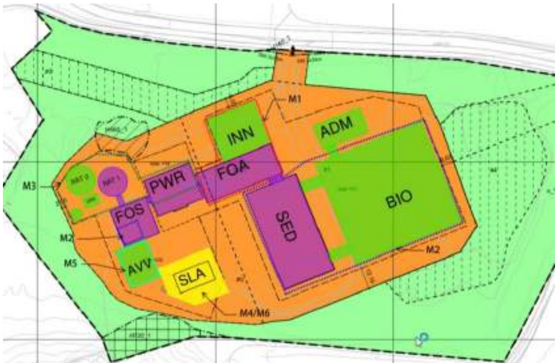
Figur 1-1 Overordnet skisse av RA-anlegget. Grønn illustrer nye bygningskropper. Lilla som eksisterende som skal bygges om. Gule som fremtidige bygg.
